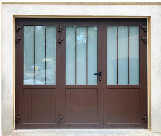
Possibilités de portes de garage avec portes battantes réalisées à partir de profils en aluminium extrudés, avec ou sans rupture de pont thermique. Remplissage avec panneau double paroi en acier et mousse polyuréthane identique aux portes sectionnelles. De série avec une serrure 1 point, crémone pompier et ouverture vers l'intérieur par défaut. Disponibles en 2, 3 ou 4 vantaux.
