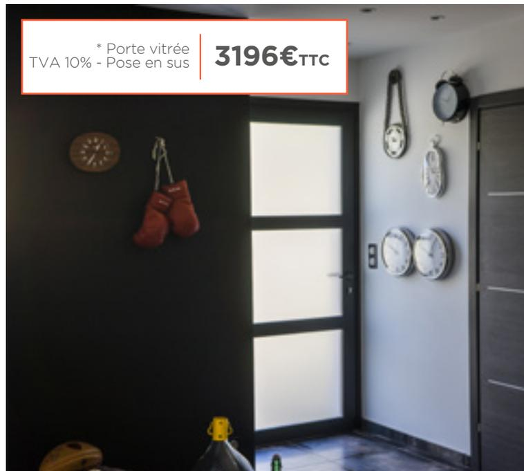
Porte un vantail avec deux traverses. Teinte 9005 granité, habillage extérieur, serrure 5 points. Double vitrage dépoli SP10/10/4 ITR + gaz argon. Dim L 1 m x H 2,15 m.
